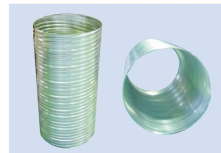
プレキャストコンクリートの代わりに用いられ、掘削した後に支柱を建て込みコンクリートを流し込んで養生します。300φ~700φ程度でよく用いられ、道路反射鏡の標準基礎寸法の長さの根入れを行います。
