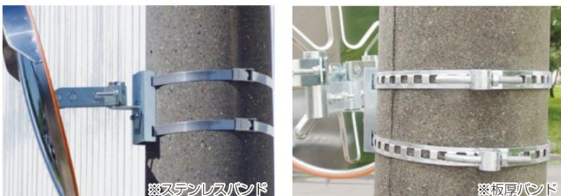
**特長** 60φ～350φまでの電柱及び270角柱以下の角柱(板厚バンドは角柱不可)に取付可能です。ステンレスバンドはラチェット方式、板厚バンドは締付ボルトにて強固な固定が可能です。400φ・450φ・350×450の二面は板厚バンドでのご提案となります。
