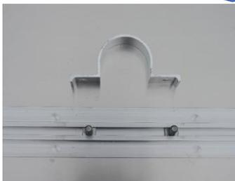
② ボルトを平リブの端よりスライドさせ取付位置に移動させます。
