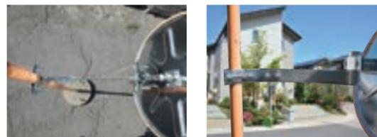
ホームミラー付属の金具では出幅が足りなかったり、出幅をおさえたい時にご利用下さい。34φ~50.8φの支柱に取り付けることが出来、長さが芯々150・250・350の三種類からお選び頂けます。外形図面④のボルトはしっかりと締めて下さい。締めが甘いと⑤のボルトがうまく入らない場合があります。
