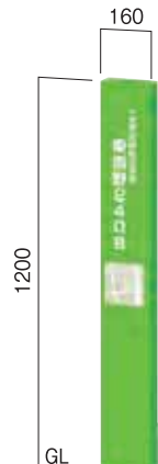
F-2 表示有効寸法 W160×H1200両面 埋込寸法 400mm 本体重量 6kg
